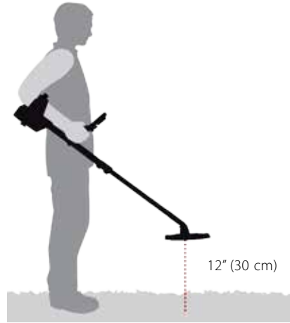
Şekil 17 – Parazit Önleme için doğru dedektör konumu
